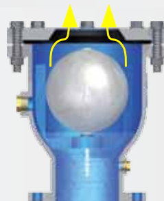
Évacuation de grandes quantités d'air durant le remplissage
