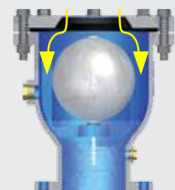
Admission de grandes quantités d'air durant la vidange on of large
