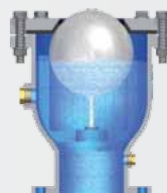
La ventouse est fermée en permanence jusqu'à la détection d'une dépression
